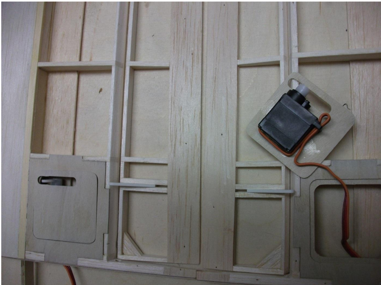
Bild: Servos eingepasst und auf Deckel verklebt – Ist absolut OK!
