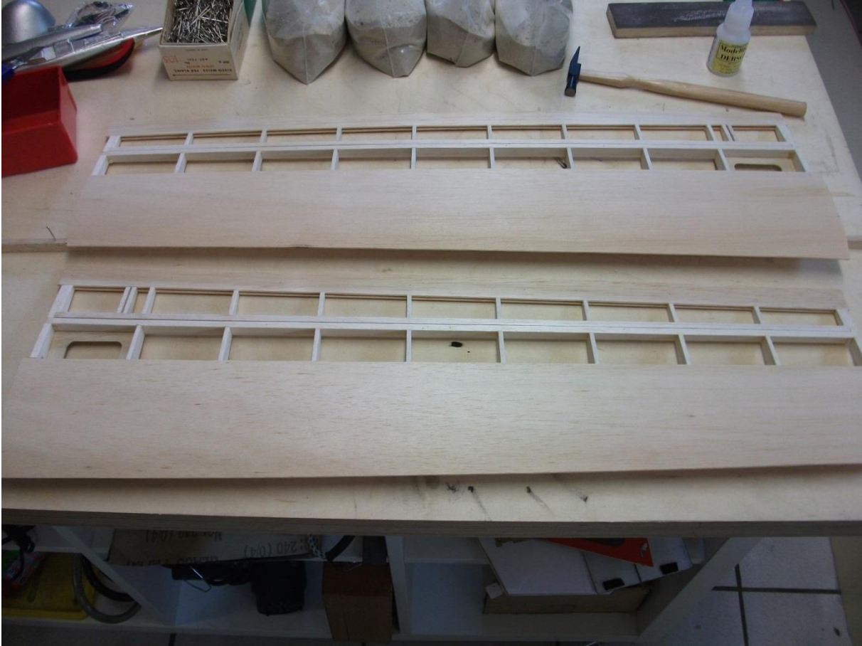
Bild: Beide Langohrflächenteile mit oberer Beplankung
